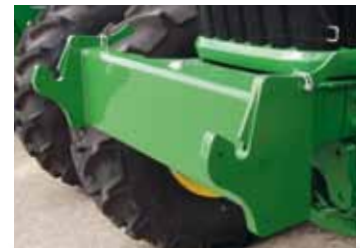
Interface pour masses monoblocs et évolutives jusqu'à 1400 kg
